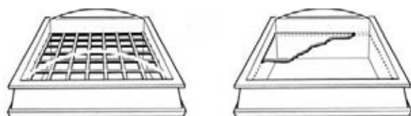
Bild 3.49: Lichtkuppel mit Gitter oder zusätzlicher einbruchhemmender Verglasung
