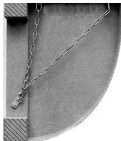
Bild 3.46: Befestigung im Mauerwerk beim Kunststofflichtschacht
